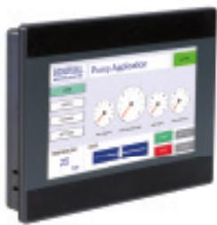
Das 7" Touch-Bedienterminal in Dunkelgrau ist speziell für Bedien- und Beobachtungsaufgaben in allen Bereichen der industriellen Automatisierung konzipiert. Das lüfterlose System mit 32 Bit Cortex A8 Prozessor und 600 MHz Takt besitzt reichlich Rechenpower und überzeugt durch angenehm schnelle Seitenumschaltung. Die Projektierungssoftware „EasyBuilder Pro“ stellt keine besonderen Anforderungen an Ihren PC, ist einfach zu bedienen und steht kostenlos zur Verfügung.
