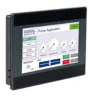
Il terminale di comando touch grigio scuro da 7" è concepito appositamente per le attività di comando e monitoraggio in tutti i settori dell'automazione industriale. Il sistema senza ventola con processore 32 bit Cortex A8 e ciclo a 600 MHz possiede un'ampia potenza di calcolo e convince grazie al cambio di pagina rapido. Il software di progettazione "EasyBuilder Pro" non richiede requisiti particolari del PC, è facile da comandare ed è disponibile gratuitamente.
