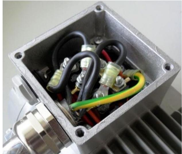
Abb. 32: Verdrahtung am Motoranschlusskasten
