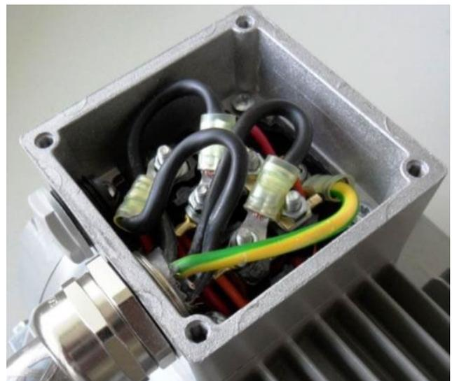
Abb. 30: Verdrahtung am Motoranschlusskasten
