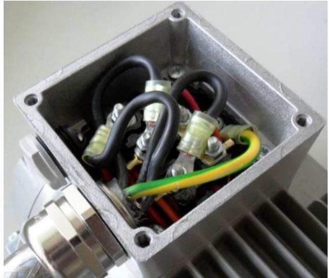
Abb. 23: Verdrahtung am Motoranschlusskasten
